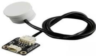
Fig.No:4 Water Level Sensor
