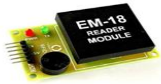
Fig. 7. RFID reader EM-18
