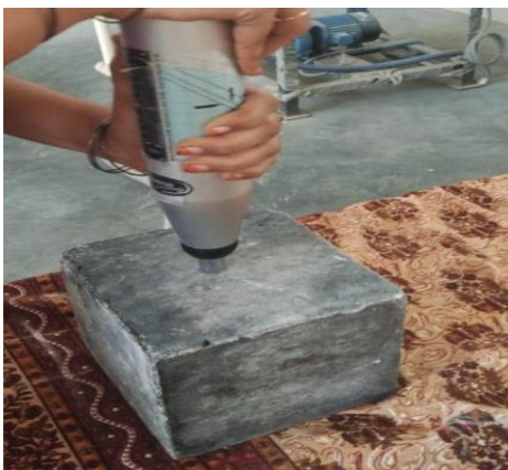
(d) Rebound hammer
