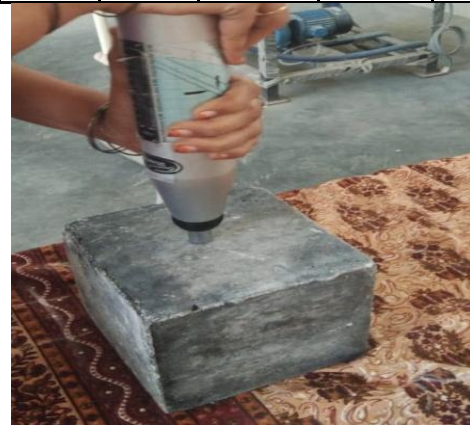
(d) Rebound hammer
