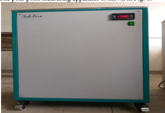
Fig. 6. Pour point apparatus - Setup
