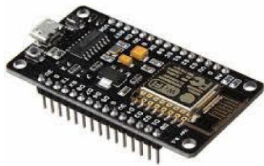
Figure 3:ESP8266 Wi-Fi module
