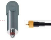
Step 2: Connect mini BNC cable to AE sensor
