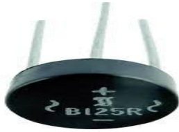
Fig: Bridge rectifier
