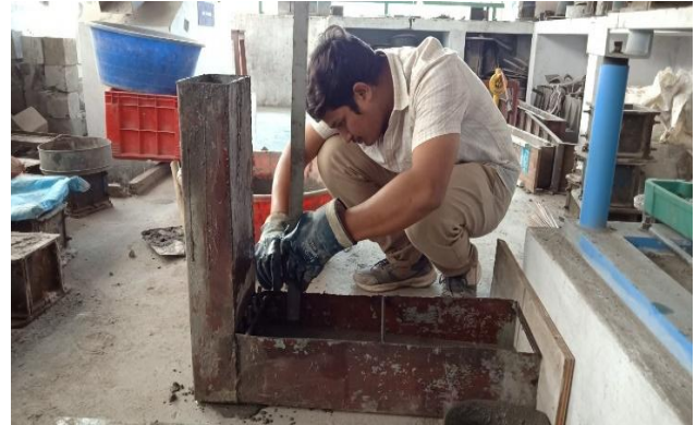
Fig: 6 L-Box Test
