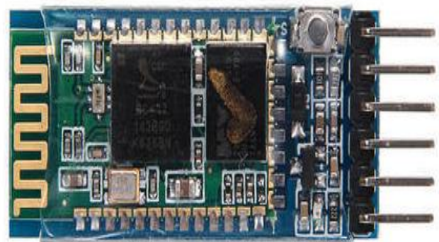
Fig 5: HC-05 Bluetooth module
