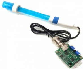
Figure-5. PH Sensor
