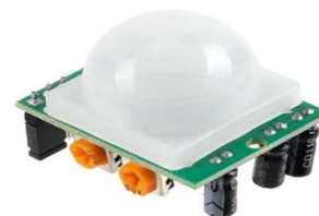
Figure-4. PIR Sensor
