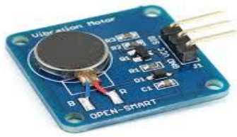
Fig. 5. Vibration motor module
